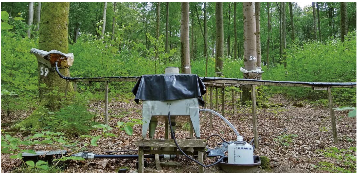
Messeinrichtung zur Erfassung des Stammablaufs bei Buche auf der Level II-Core-Fläche Spessart
