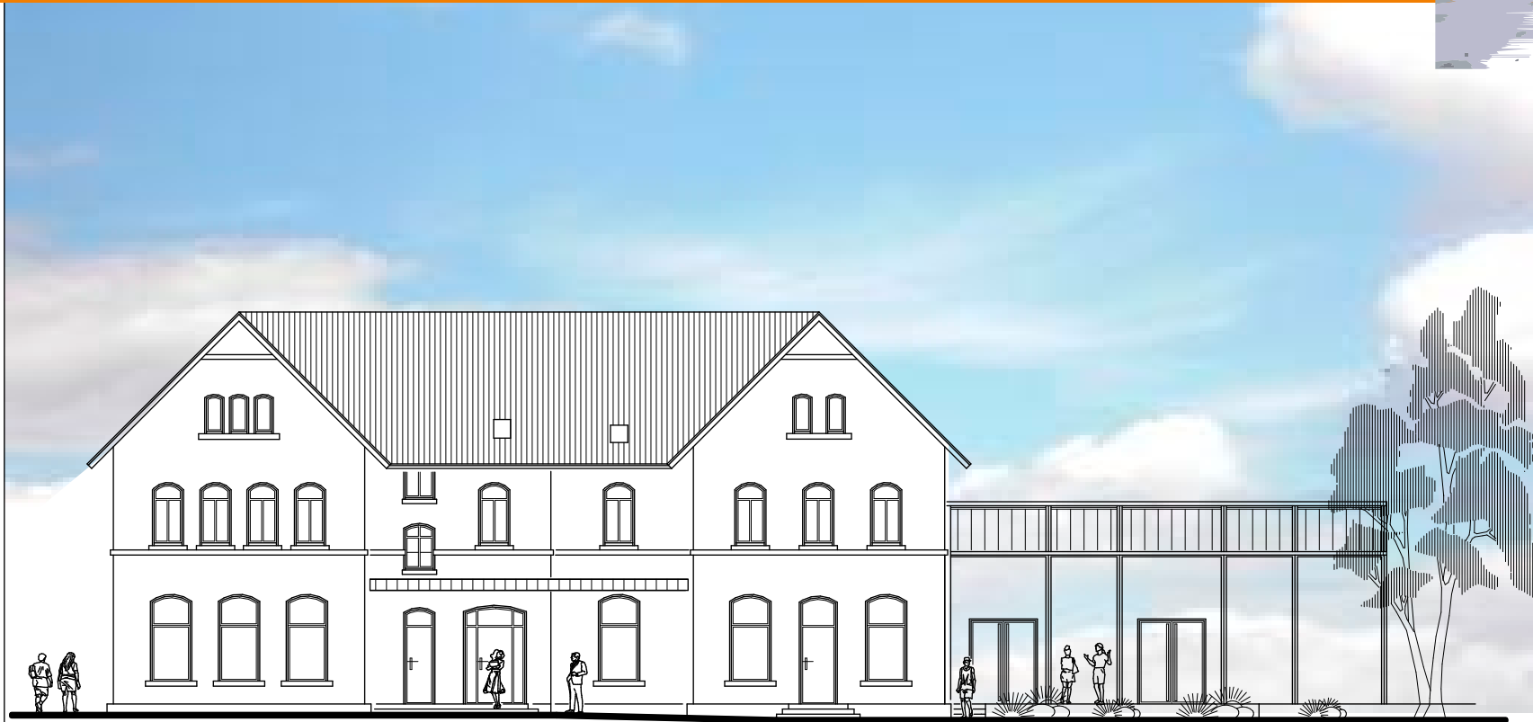
ANBAU ALS STAHL-GLAS KONSTRUKTION
