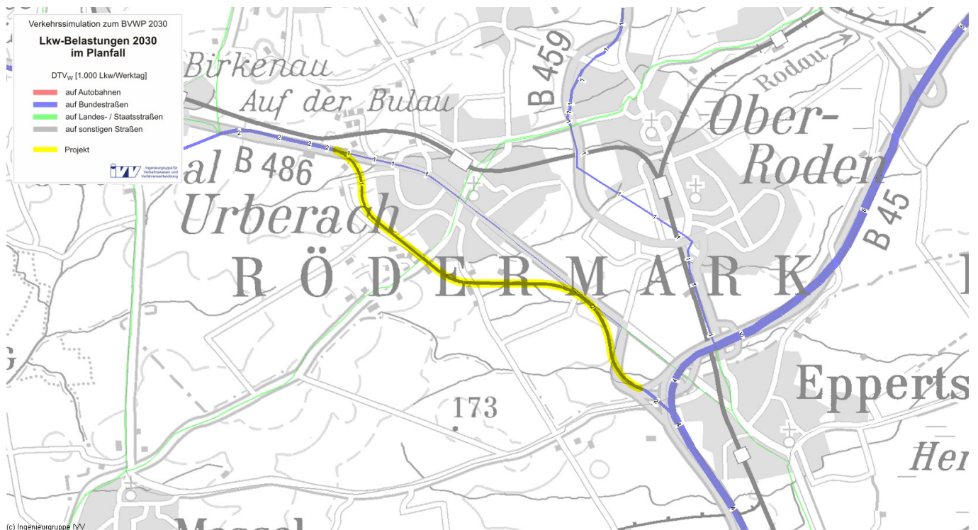
Abb. 5: Lkw-Querschnittsbelastungen des DTV w im Planfall 2030
