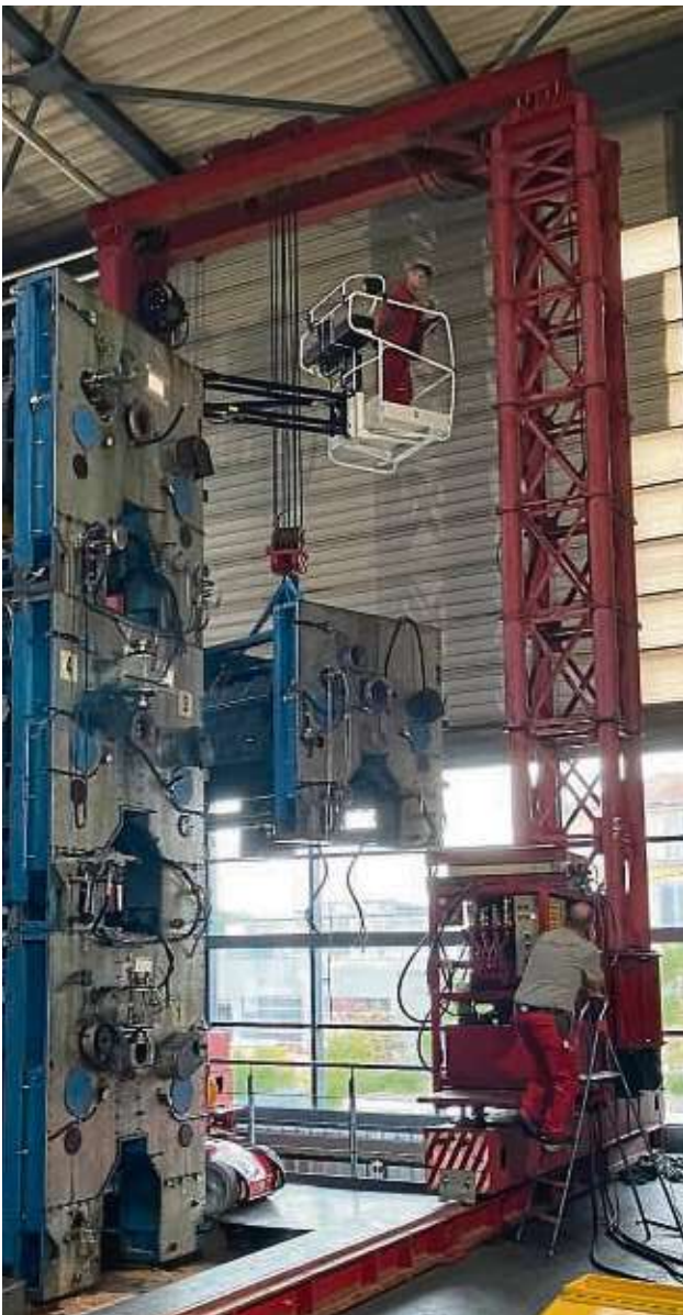
Zentimeterarbeit: Das 16 Tonnen schwere Druckwerk, das vom Druckturm (links) gehoben wird, muss durch eine passgenaue Öffnung im Betontisch nach unten abgesetzt werden.
